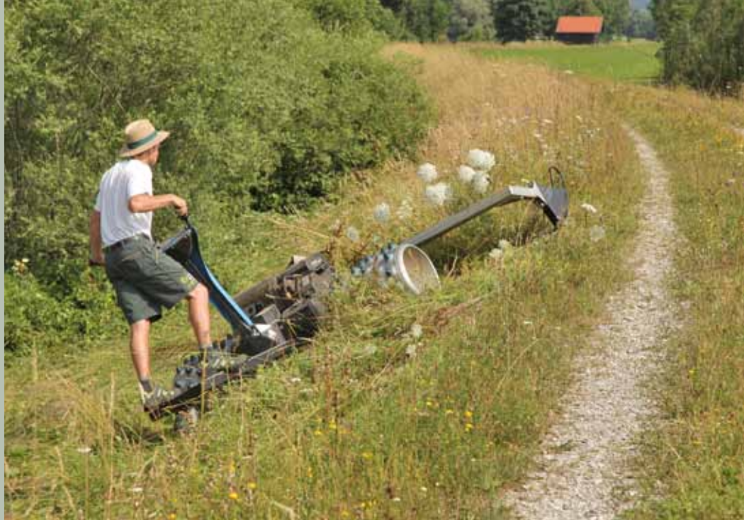
Die Stachelwalzenbereifung unseres Brielmaier Motormähers macht das Arbeiten an steilen Hanglagen möglich.
